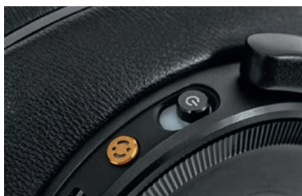
Na bocznej krawędzi muszli umieszczono dwa przyciski, włącznik zasilania oraz selektor trybów DSP; uruchamiamy nim także (poprzez dłuższe przytrzymanie) procedurę autokalibracji.
